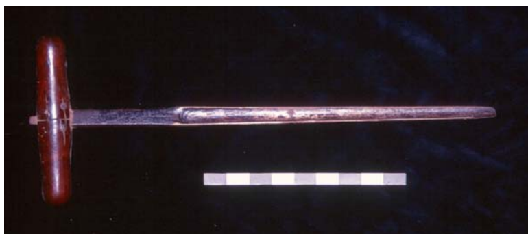
Fig. 32: Coitela para o labrado interior do cono das requintas. Pertenceu a Joaquín García García (1856-1934). Barra=18 cm.
